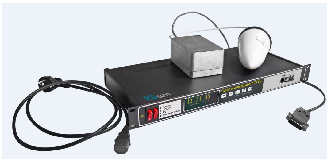
Рисунок 1. Общий вид комплекса измерительно-вычислительного СТВ-01.
